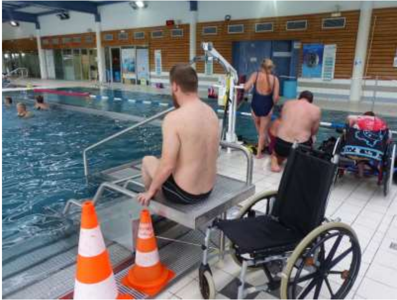
Illustration d'un escalier à transfert
